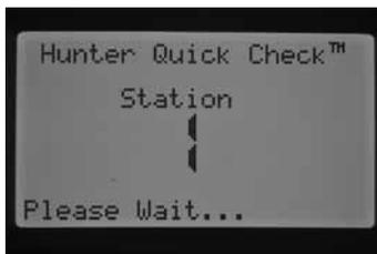
Le programmeur effectue une recherche sur toutes les stations pour détecter un chemin à courant élevé entre les bornes de station. Lorsqu'un court-circuit est détecté dans une station, un message d'erreur s'affiche à l'écran du programmeur pour chaque station défectueuse.
