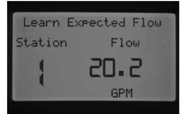
Une fois le numéro de station correct affiché, placez le sélecteur sur Marche. Le programmeur passe à nouveau en mode de test de diagnostic pour cette station en particulier. Il active ensuite la station et le processus d'apprentissage peut durer jusqu'à une minute. Une fois que le programmeur a appris le débit, il arrête les stations et revient à l'écran principal de la date/l'heure.
