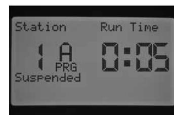
Une commande à distance d'une station unique désactive l'état de la sonde (que la station soit réglée pour répondre ou non) et cette station effectue l'arrosage pendant le temps de fonctionnement désiré. Lorsque vous activez un programme manuel à l'aide d'une télécommande, le programmeur détecte les stations programmées pour répondre à une sonde. Ces stations n'effectueront pas l'arrosage et seront en mode Suspendre.
