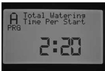
Le programmeur identifie les stations ayant un temps de fonctionnement associé à chaque programme et additionne les temps de fonctionnement de toutes les stations pour parvenir au temps de fonctionnement total ou à la durée d'arrosage de ce programme. Le temps d'arrosage total ne tient pas compte des délais de station ni des durées d'arrosage et de réessuyage survenant pendant l'arrosage.
