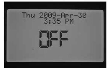
Il est également possible de définir une période programmable pendant laquelle le programmeur restera éteint dans la position du sélecteur Arrêt du système. Il s'agit de la fonction Programmable Rain Off (Arrêt d'arrosage programmable), qui sera abordée dans la section correspondante.
